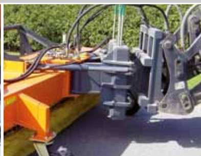
optimale Boden Anpassung durch robusten 3D-Niveaueausgleich
