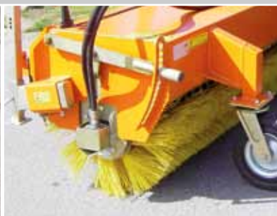
zwei leistungsstarke, innenliegende Motoren für den Bürstenantrieb
