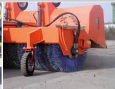
einfache Bürstennachstellung über Rasthebelsystem
