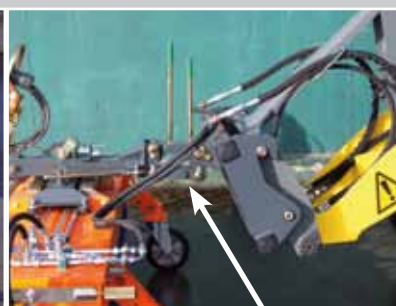
Chargeur frontal avec parallélogramme et compensateur à pendule, incl. indicateur de hauteur
