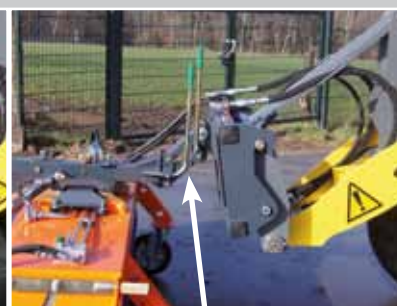
Chargeur frontal avec parallélogramme et compensateur à pendule, incl. indicateur de hauteur
