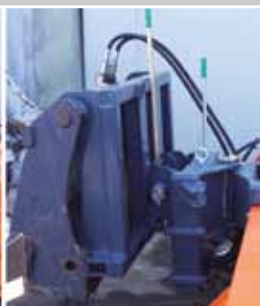
Coulissant aux roulements avec indicateur de hauteur et adaptateur pendulaire
