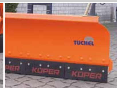
Abkantungen im seitlichen und oberen Schildbereich
