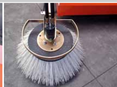
Brosse latérale actionnée hydrauliquement
