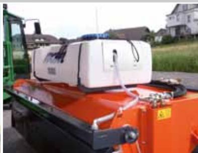
Système de pulvérisateur avec réservoir d'eau 100 / 200 litres
