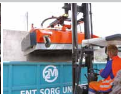
Vidange hydraulique du bac de ramassage (standard)
