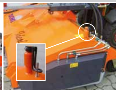
Ajustage facile du balai incl. mécanisme flottant par levier de verouillage
