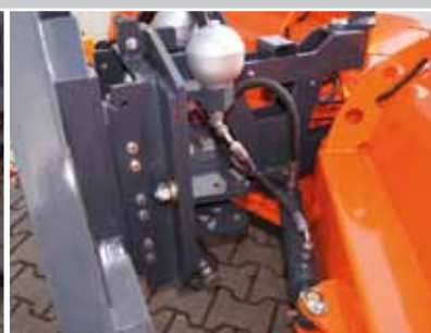
hydraulische Verstellung der Klappflügel
